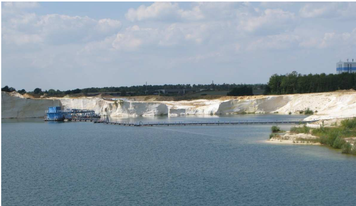
Abb. 5.1.14 Gewinnung von hellen, eisenarmen Quarzsanden bei Uhry, Landkreis Helmstedt.
