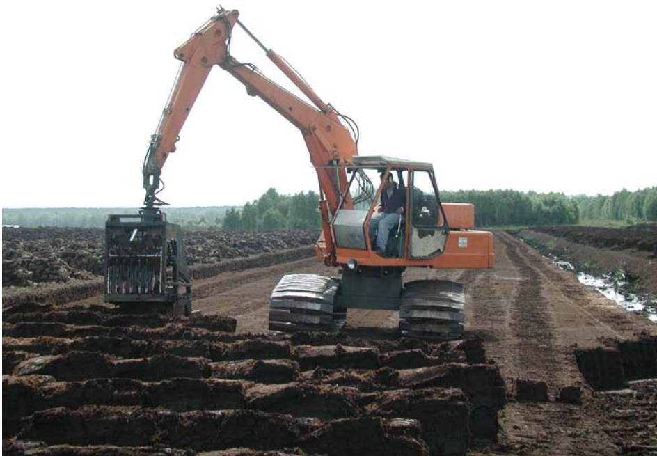
Abb. 5.9.2 Torfabbau mit dem Stechkasten.
