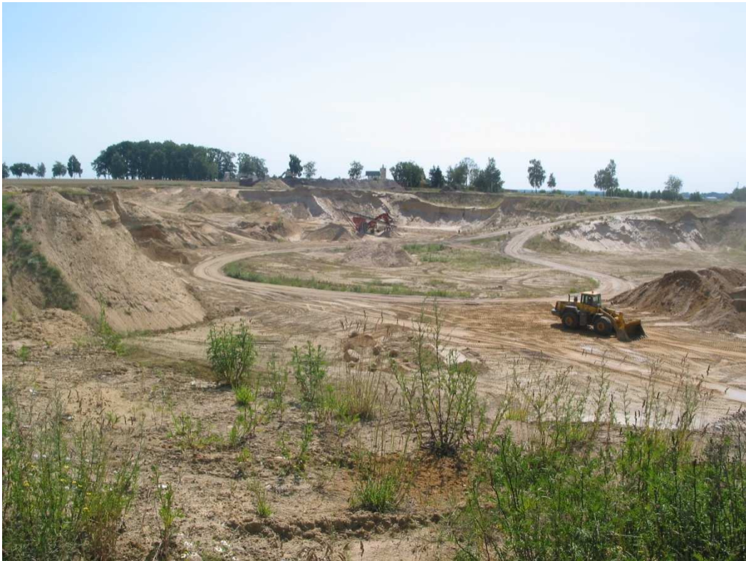
Abb. 5.1.6 Trockenabbau von Sand mittels Radlader im Landkreis Verden.
