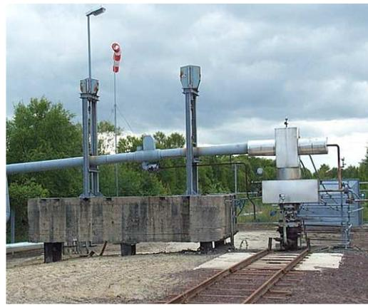
**Abbildung 8: Dampfinjektionsbohrung**
