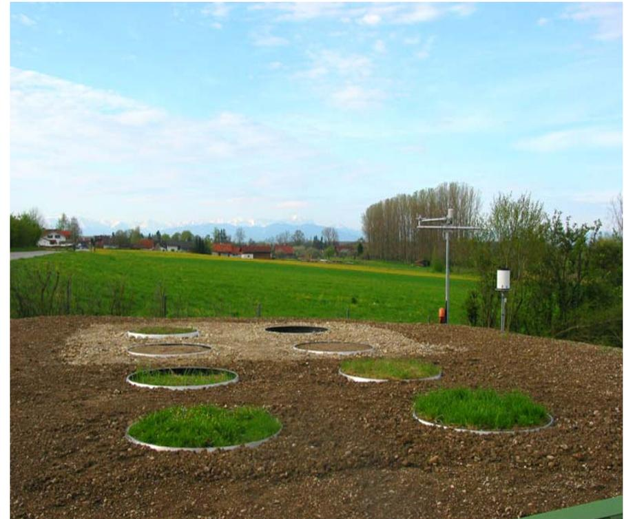
durch Wägung des Auslaufes präzise und zeitlich hoch aufgelöste Erfassung der Sickerwasserraten und Konzentrationen möglich
