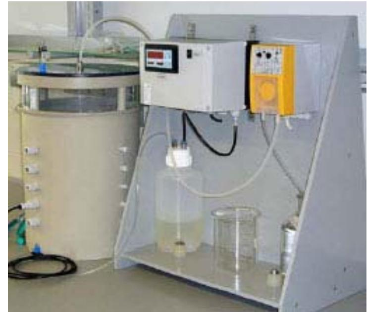
durch Wägung des Auslaufes präzise und zeitlich hoch aufgelöste Erfassung der Sickerwasserraten und Konzentrationen möglich
