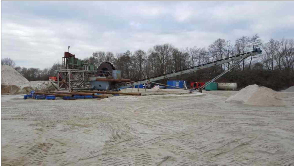
Abb. 6: Siebmaschine mit Entwässerungsschöpfrad und Förderband
