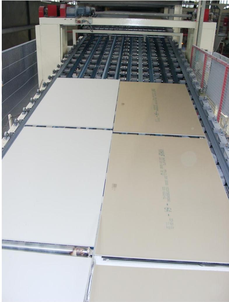
**Abb. 5.5.3:** Fließbandproduktion von Gipskartonplatten.
