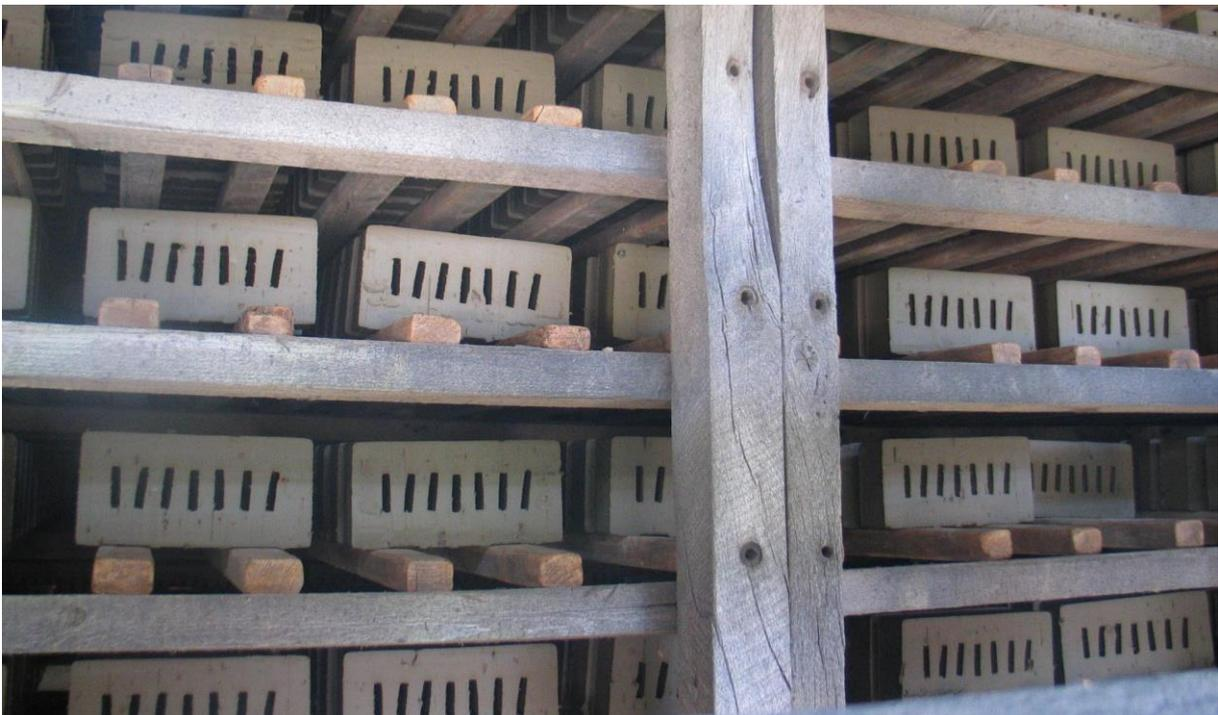
**Abb. 5.2.9:** Auch heute noch werden die Klinkerrohlinge einzeln im Hofmannschen Ringofen aufgestapelt und nach dem 14-tägigen Brennvorgang manuell wieder dem Ringofen als original Wittmunder Klinker entnommen. Diese traditionsreiche Produktionsmethode lässt sich nur durch ein genaues Auge und die exakte Bemessung der Torfbefuerung per Hand steuern.
