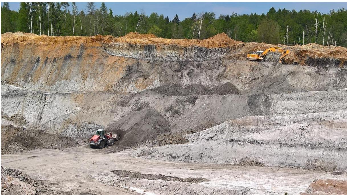
**Abb. 5.2.4:** Gewinnung von Wealden-Tonstein im Hils, der vor allem in der Umwelttechnik als Dichtungston eingesetzt wird.
