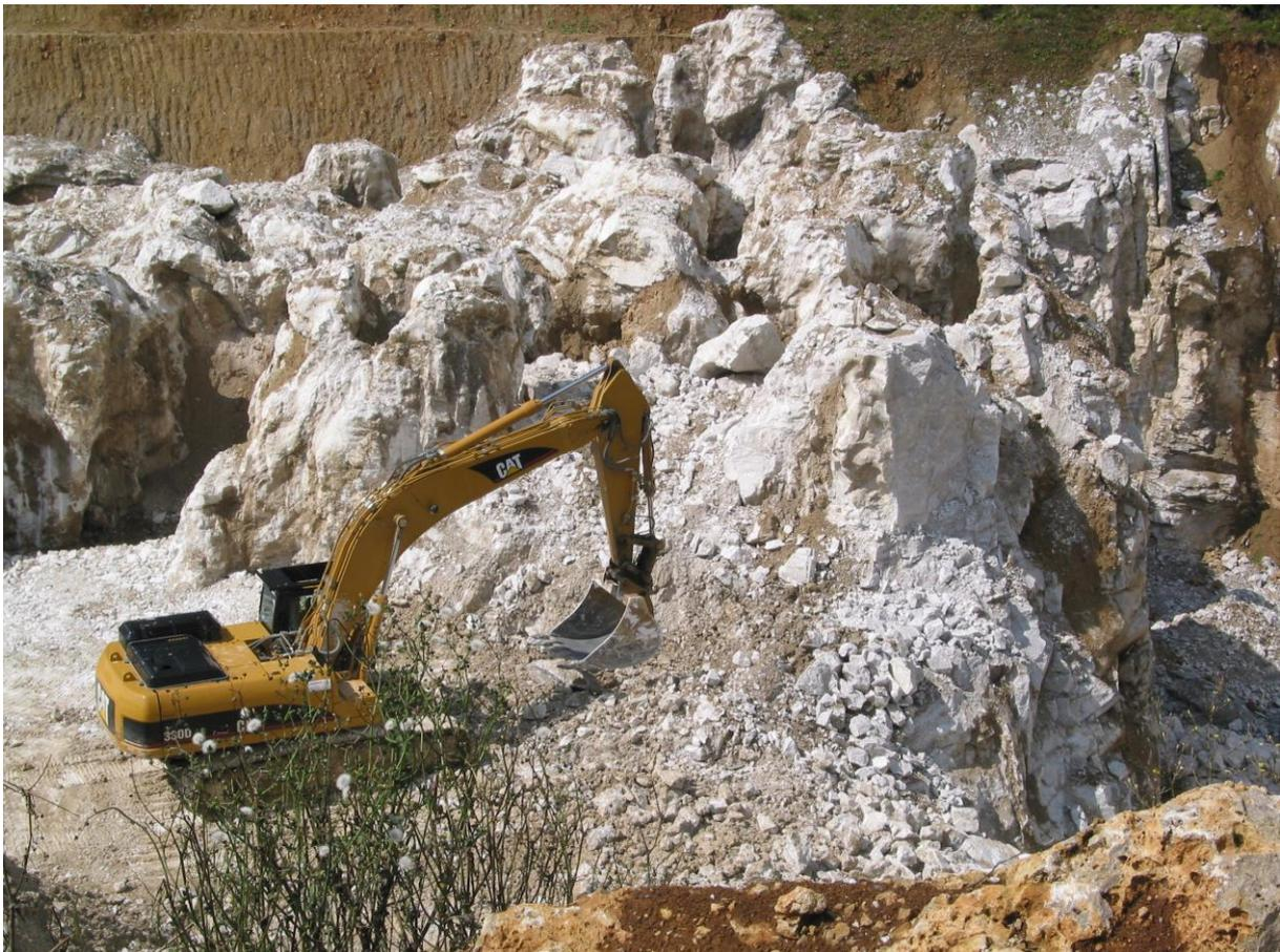
**Abb. 5.5.2:** Für den Abbau freigelegte stark verkarstete Gipsoberfläche in einem Abbau am Südharz.
