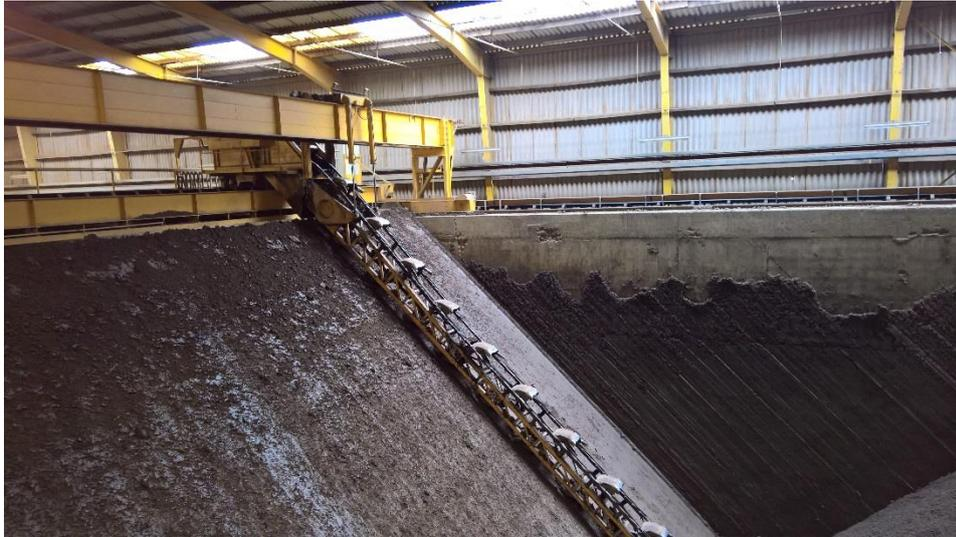
**Abb. 5.2.2:** Lagerung und Aufbereitung von Lauenburger Ton mittels Quersumpfanlage.
