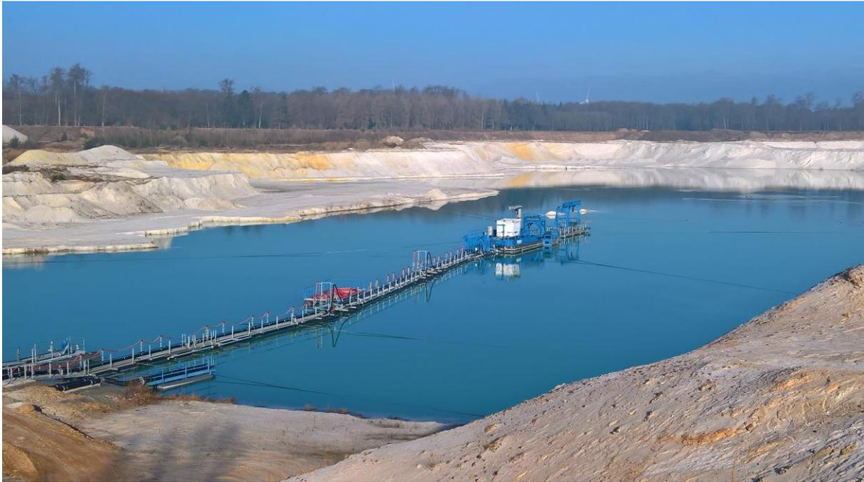
**Abb. 5.1.15:** Gewinnung von hellen, eisenarmen Quarzsanden bei Uhry, Landkreis Helmstedt.
