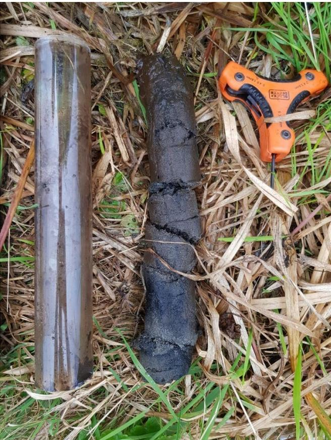
**Abb. 10: Sedimentprobe mit Liner**
