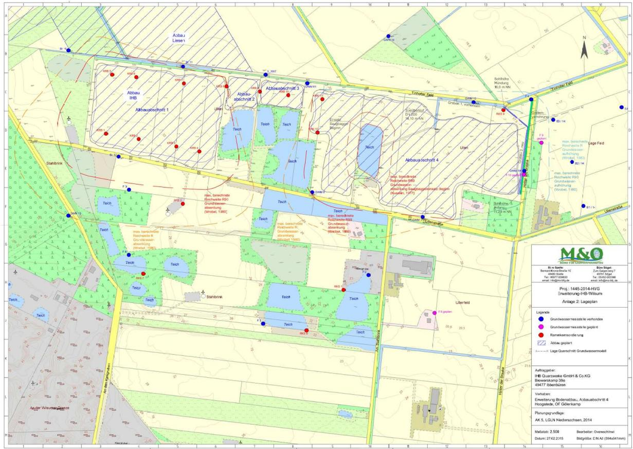
**Abbildung 4: Abbauflächen (Abbauabschnitte) und Reichweiten der Grundwasserspiegeländerungen (Unterlage 5, Anlage 2)**
