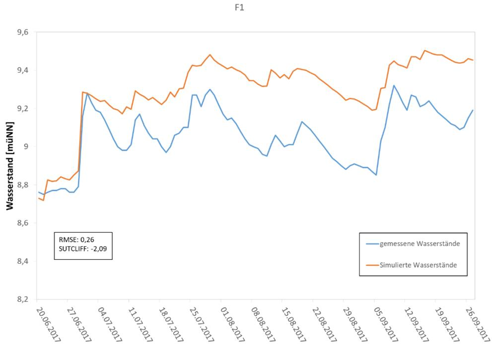
Abbildung 32: Gemessene Wasserstände gegenüber simulierten Wasserständen der Messtelle F1.
