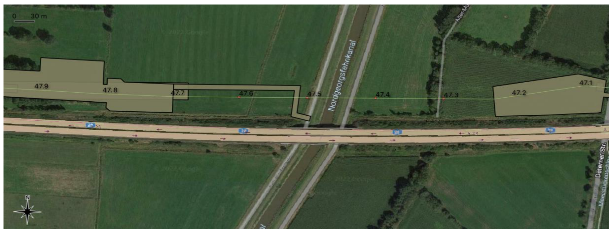
Abbildung 32: KB OL 02 - Nordgeorgsfehnkanal mit Arbeitsstreifen und Zufahrt sowie Unterbrechung im Bereich der geschlossenen Querung
