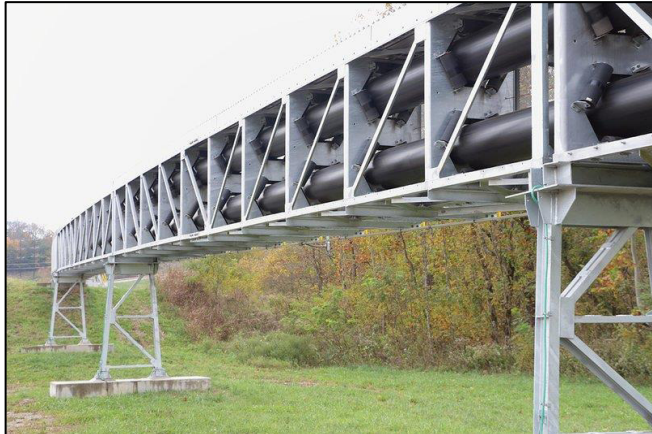
Abb. 6-7 Pipe Conveyor (BEUMER GROUP)
