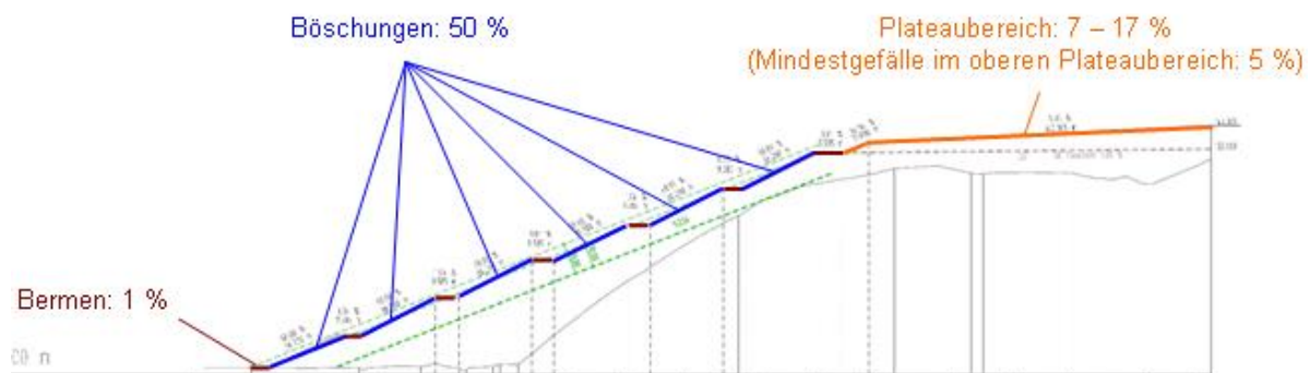
Abb. 4: Generalisierter Vertikalschnitt durch die Halde Niedersachsen (Bildgrundlage: K+S Entsorgung GmbH)
