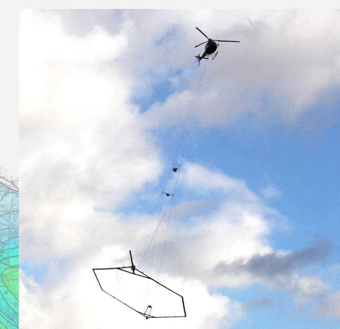
Abbildung 2: SkyTEM-Messsystem im Flug.
