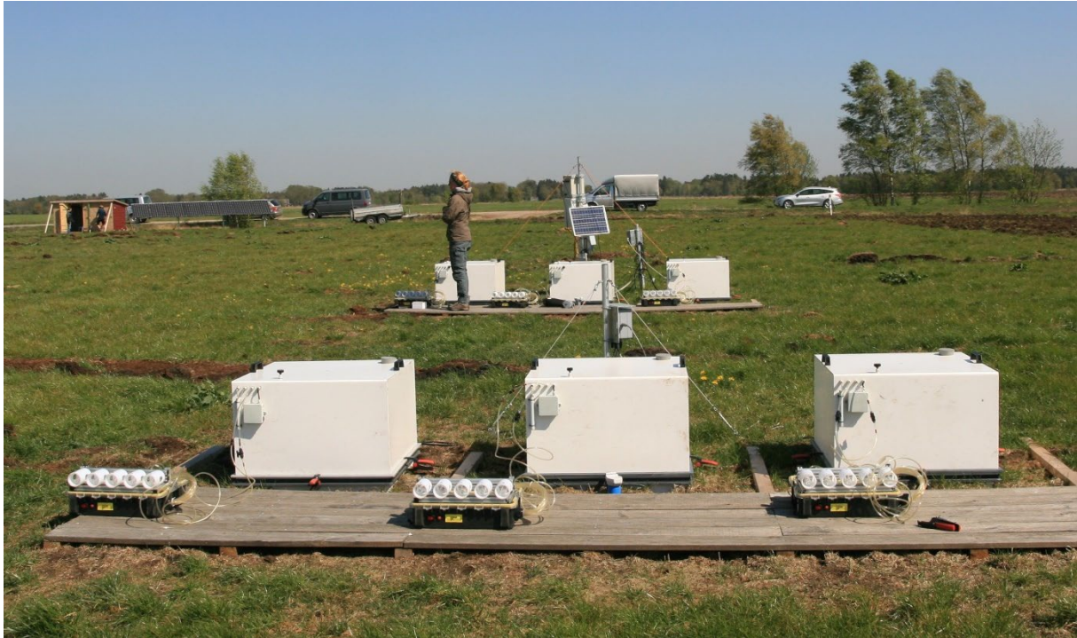
Abbildung 85: Einrichtungen zur Messung der Methan- und Lachgasflüsse (UFB_1) mit nicht transparenten Hauben und semi-automatischen Probenehmern auf einem Dränrohr (vorne) und in der Mitte zwischen zwei Dränrohren (hinten).
