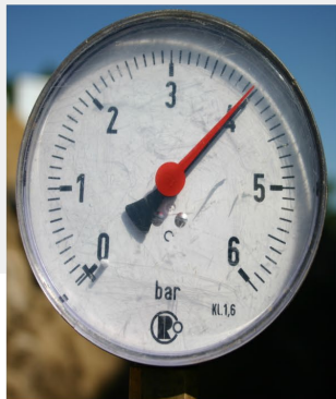
11. Druckprobe bei 4-5 bar
