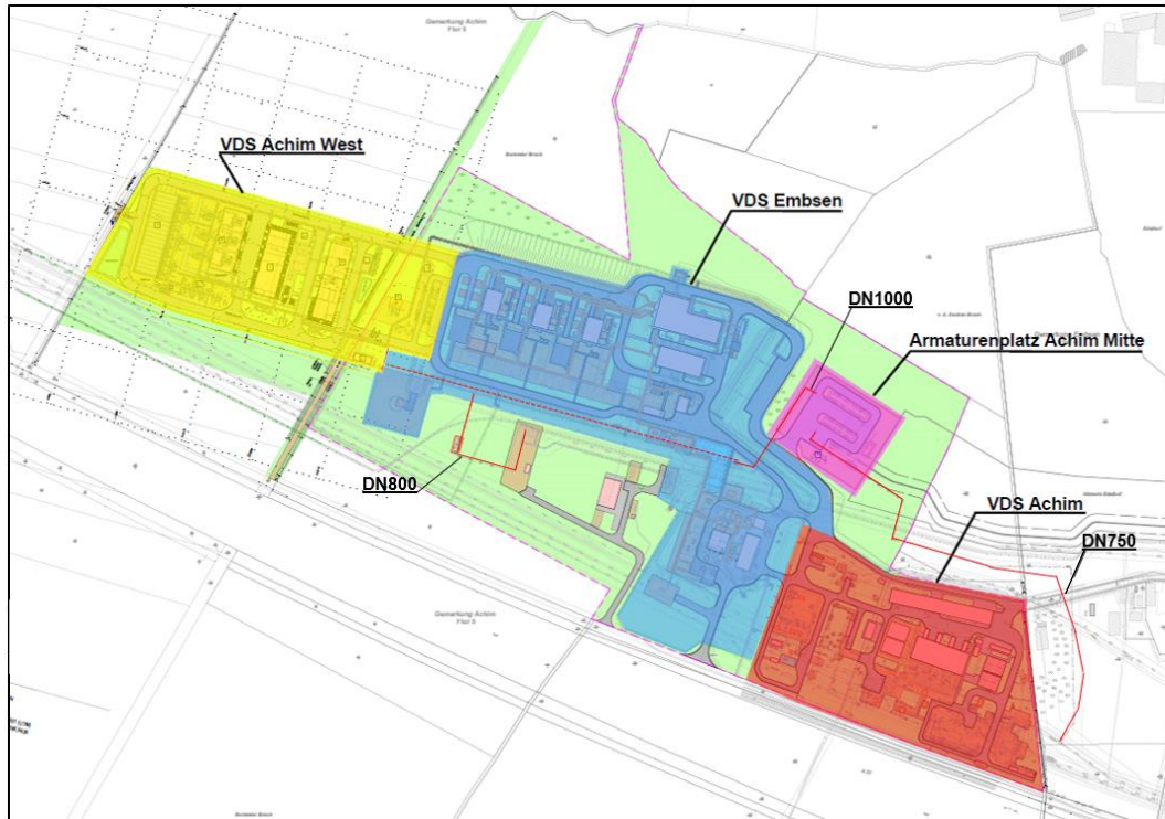
Abbildung 1: Übersichtskarte der Lage des Verdichterstations-Komplexes im Bereich Achim mit den geplanten Einheiten der VDS Achim West, des Armaturenplatzes Achim Mitte sowie den Leitungen DN750, DN800 und DN1000.
