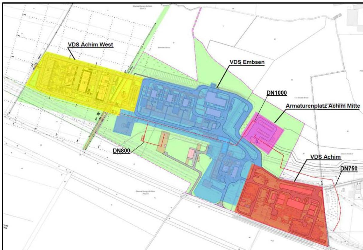
**Abbildung 4: Die Verdichterstationen „Achim“ und „Embsen“ mit den beantragten Vorhabensbestandteilen VDS „Achim West“, ETL 9087.215 (DN 800), ETL 182.010 (DN 1000), ETL 32.010 (DN 750) und Armaturenplatz „Achim Mitte“ (Quelle: Unterlage E4.01)**
