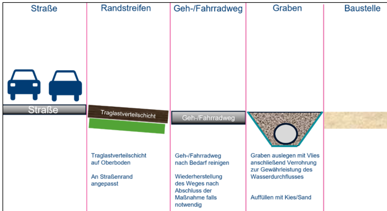
Abbildung 13: Temporäre Zufahrten - Regelaufbau
