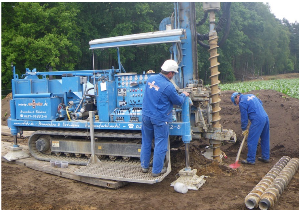
Abbildung 3 Bohrgerät für Tiefenbohrung
