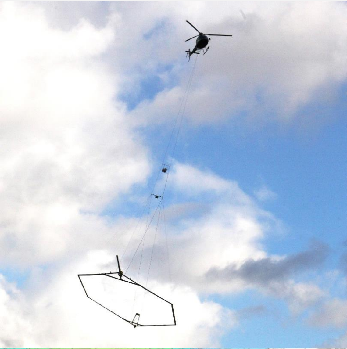
Abbildung 2: SkyTEM-Messsystem im Flug.
