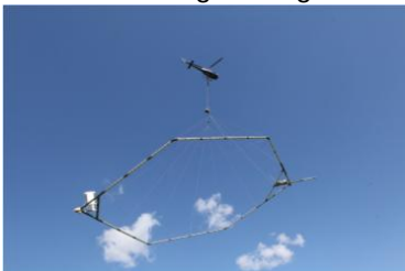
Abb. 4: rechts: Hubschrauber mit SkyTEM-Antenne; links: Befliegungsgebiet
