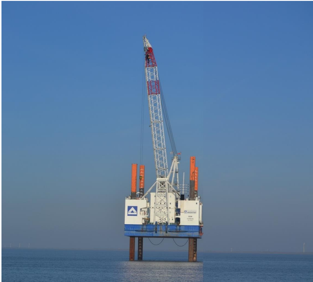
Abb. 2 Beispielhafte Darstellung eines Jackup Rigs (eigene Abbildung)
