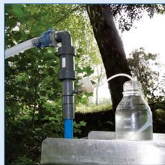
Mittels eines Biogas-Monitors werden ausgewählte Gase im „Gas erfüllten Volumen“ in der Durchflussarmatur gemessen (CH<sub>4</sub>, CO<sub>2</sub>, H<sub>2</sub>S).
