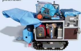
In schwer zugänglichem Gelände werden Probenahmen mit dem Raupenfahrzeug durchgeführt.
