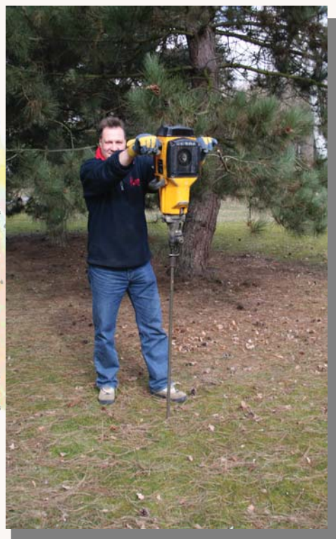
Cobra-Motorhammer Einsatzbereich: Unterstützung von Handbohrungen im Lockergestein
