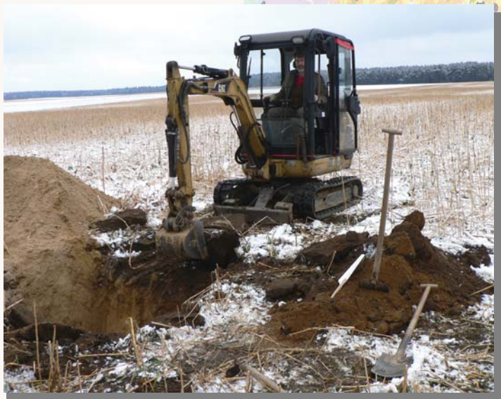
Minibagger Einsatzbereich: Anlage von Profilgruben, bis 2 m Tiefe
