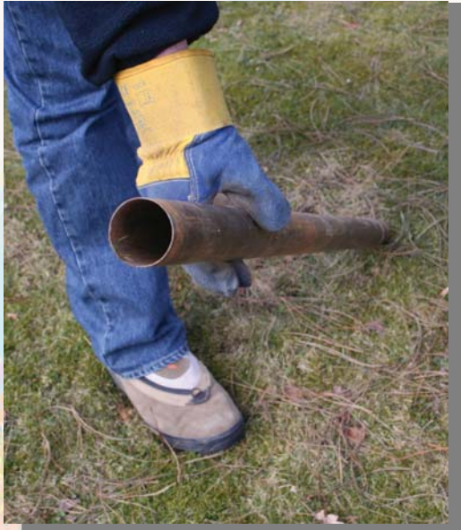
Stechrohr Einsatzbereich: wasserreiche Küstenablagerungen, Marschen, Moore. Bis ca. 20 m Tiefe
