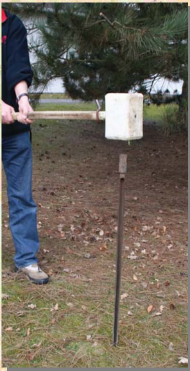
Pürckhauer und Schlag-Hebe-Kombination Einsatzbereich: Unterstützung von Handbohrungen im Lockergestein
