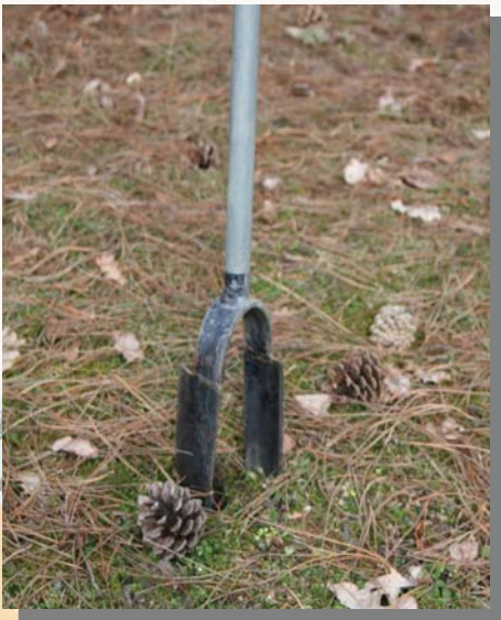
Flügelbohrer Einsatzbereich: Oberflächen- nahe Probennahme im Lockergestein
