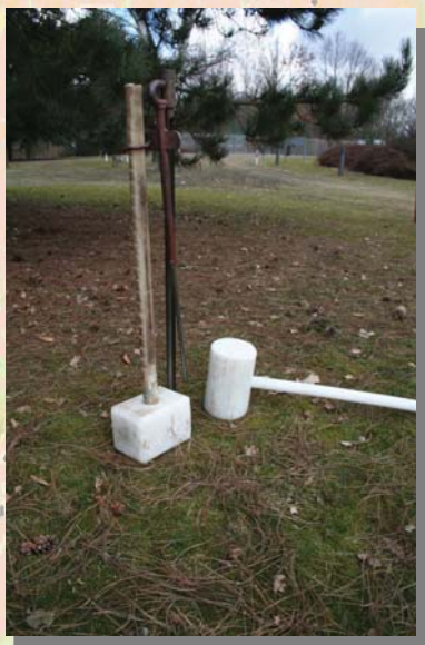
Pürckhauer und Schlag-Hebe-Kombination Einsatzbereich: Unterstützung von Handbohrungen im Lockergestein
