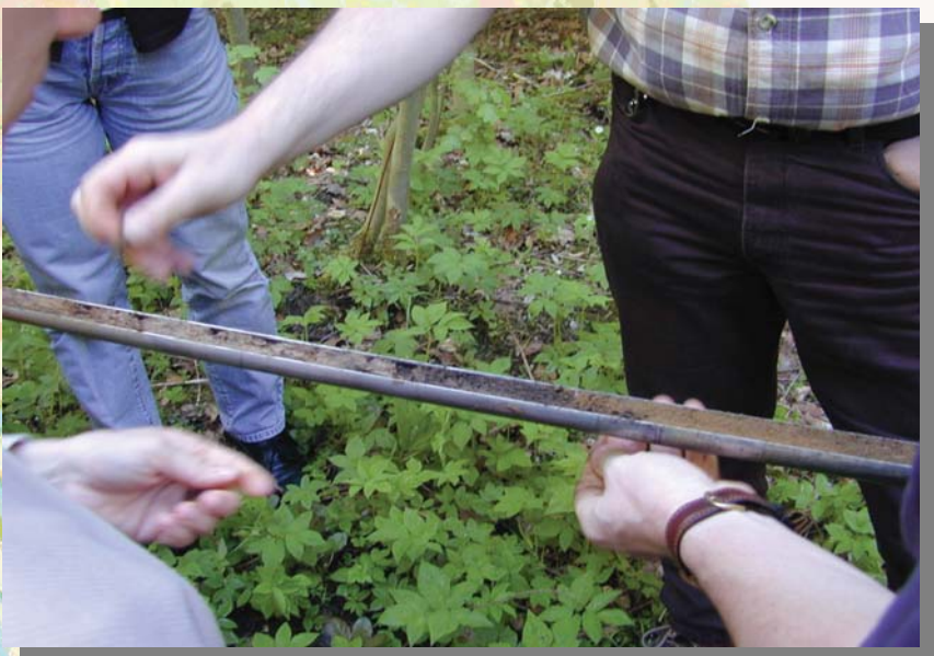
Linnemannspitze mit Bohrprofil Einsatzbereich: Lockergesteine bis ca. 15 m Tiefe
