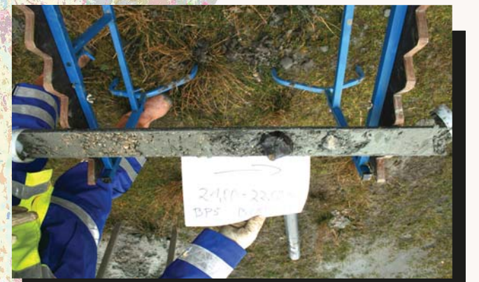
Rammkern Tiefe: 21,00-22,00 m Gchiebemergel mit Steinen
