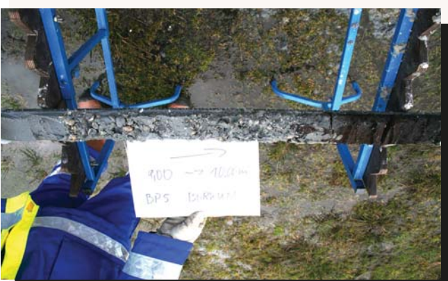
Rammkern Tiefe: 9,00-10,00 m Marine Ablagerungen mit Muschelresten
