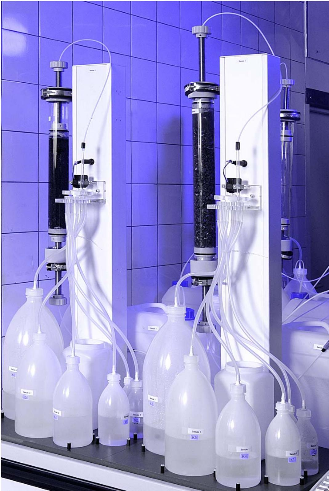
**Abbildung 1: Zwei Einheiten der Säulenelutionsanlage zur Durchführung von Perkolationsverfahren mit Aufwärtsströmung**
