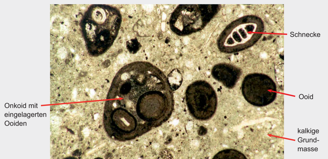
Dünnschliff eines Kalksteins des Korallenooliths (Oberer Jura, Weserbergland). Eisenreiche Ooide (runde bis eiförmige Rindenkörner) und Onkoide (schlecht gerundete Rindenkörner) aus dem tieferen Korallenoolith in einer feinkörnigen kalkigen Grundmasse; Bildbreite ca. 3 mm
