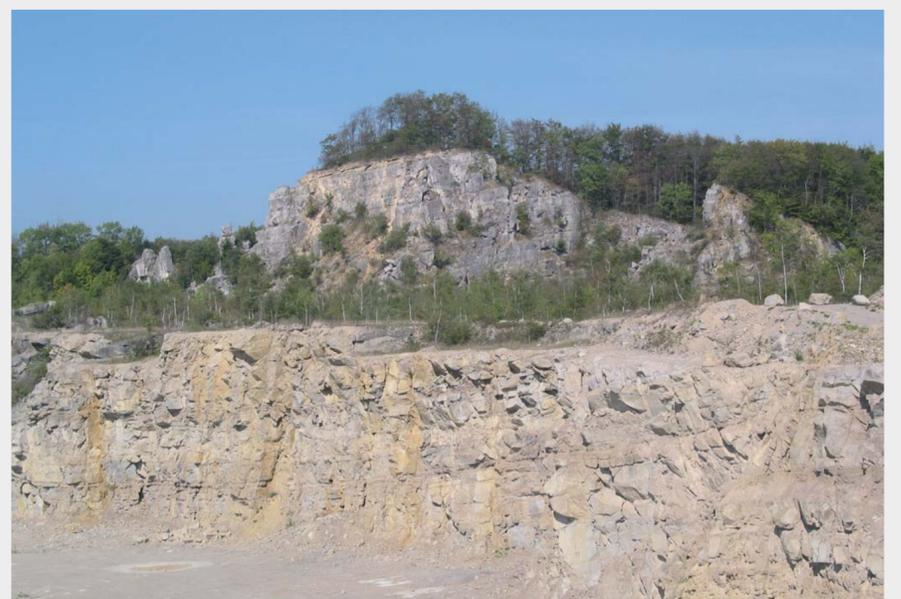
Gewinnung von dolomitisiertem Kalkstein (Oberer Jura) bei Salzhemendorf, der fast ausschließlich für die Eisen- und Stahlerzeugung verwendet wird.
