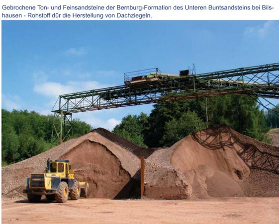
Gebrochene Ton- und Feinsandsteine der Bernburg-Formation des Unteren Buntsandsteins bei Bilshausen - Rohstoff für die Herstellung von Dachziegeln.
